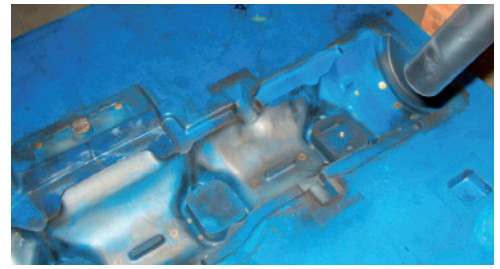
Kernkasten-Reinigung in einer Graugießerei
