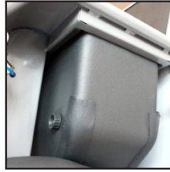
Isolierter Trockeneisbehälter mit einer Kapazität von 9 kg
