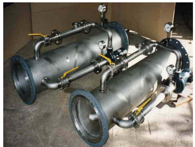
Zuverlässige CO 2 -Löslichkeit dank dem speziellen Design des statischen Mixers
