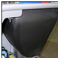
Isolierter Trockeneisbehälter mit einer Kapazität von 23 kg
