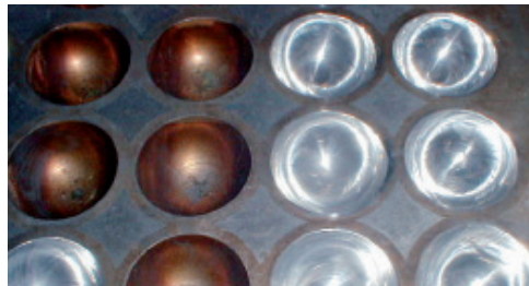
Reinigung von Formen zur Produktion von Tennisbällen
